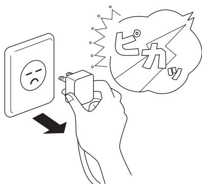
雷による一時的な過電流で電子部品が損傷する恐れがあります。
