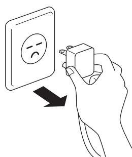
絶縁劣化による感電や漏電火災の原因になります。
