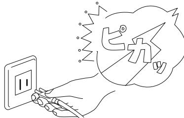
雷による一時的な過電流で電子部品が損傷する恐れがあります。
