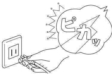
雷による一時的な過電流で電子部品が損傷する恐れがあります。
