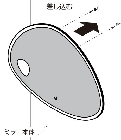
5. 結線し、ミラー本体裏面の壁面取付穴を取付ネジに差し込みます。
