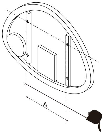
1. ミラー本体裏面の壁面取付位置のサイズを計ります。
