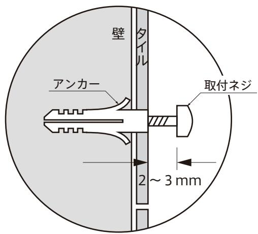
4. 穴を開けた位置にアンカーを使用して、取付ネジを取付けます。
