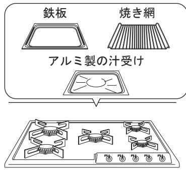
コンロを覆うような鉄板や大き過ぎる鍋、焼き網、アルミ製の汁受けなどを使用すると、異常燃焼し、一酸化炭素中毒になる恐れがあります。
