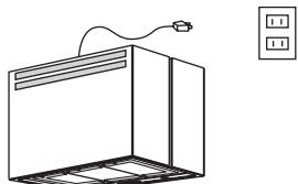
絶縁劣化による感電や漏電火災の原因になります。
