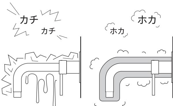
凍結破損で漏水し、家財等を濡らす財産損害発生の恐れがあります。
