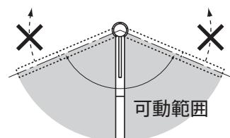
シングルレバー混合水栓の場合、吐水パイプは360°回転しますが、水受け先がない場合の吐水は必ずシンク内に納めてください。
