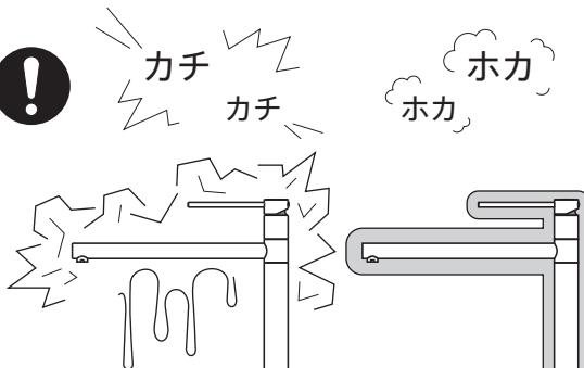
凍結破損で漏水し、家財等を濡らす財産損害発生の恐れがあります。
