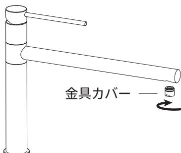
2 金具カバーから泡沫金具を取り出します。
