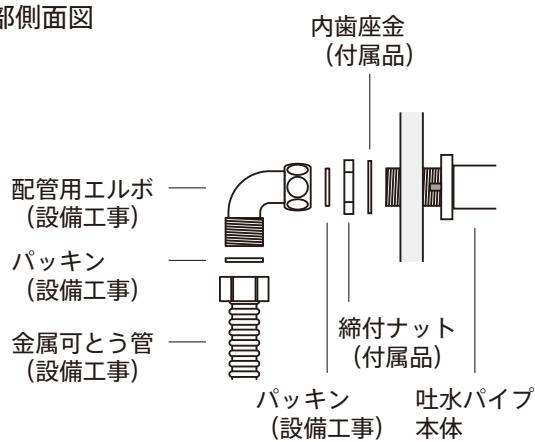
水栓配管図 (背面側より)
