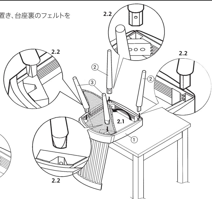
4.1. 3で取付けたボルト⑤⑥へ、ワッシャー⑧、スプリングワッシャー⑨、六角ナット⑩の順に通してスパナ⑪でしっかりと締めて前脚②後脚③を台座①に固定します。
