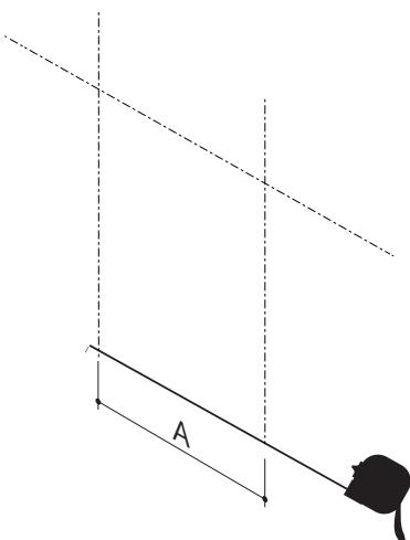
1. ミラー本体裏面の壁面取付位置のサイズを計ります。
