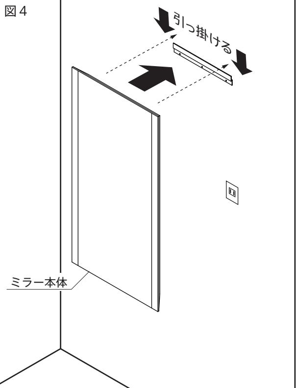
4. 壁側の引っ掛け金具にミラー本体裏面の引っ掛け金具を引っ掛けます。
