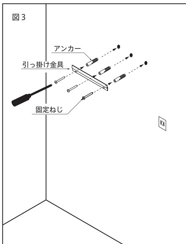
3. 穴を開けた位置にアンカーを使用して、取付ネジにて引っ掛け金具（壁側）を取付けます。
