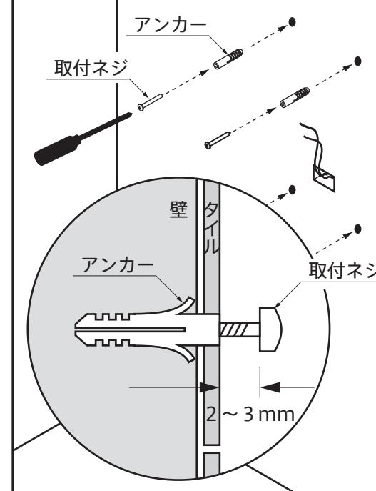
4. 穴を開けた位置にアンカーハーネスを使用して、取付ネジを取付けます。
