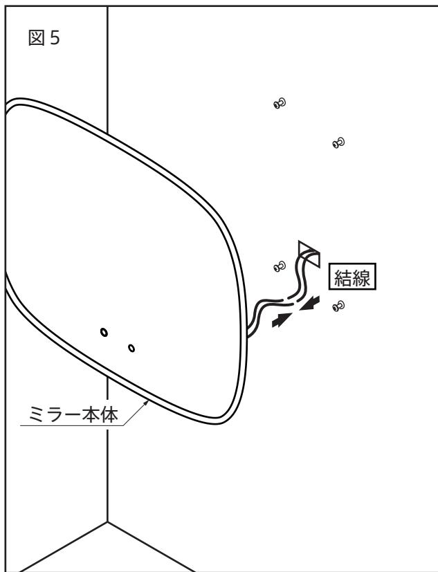
5. ミラー本体から出ている電源コードの先をカットし、建築側の電源コードと結線します。
