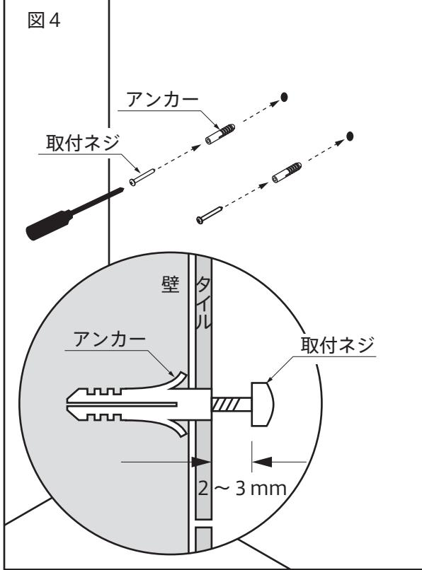
4. 穴を開けた位置にアンカーを使用して、取付ネジを取付けます。
