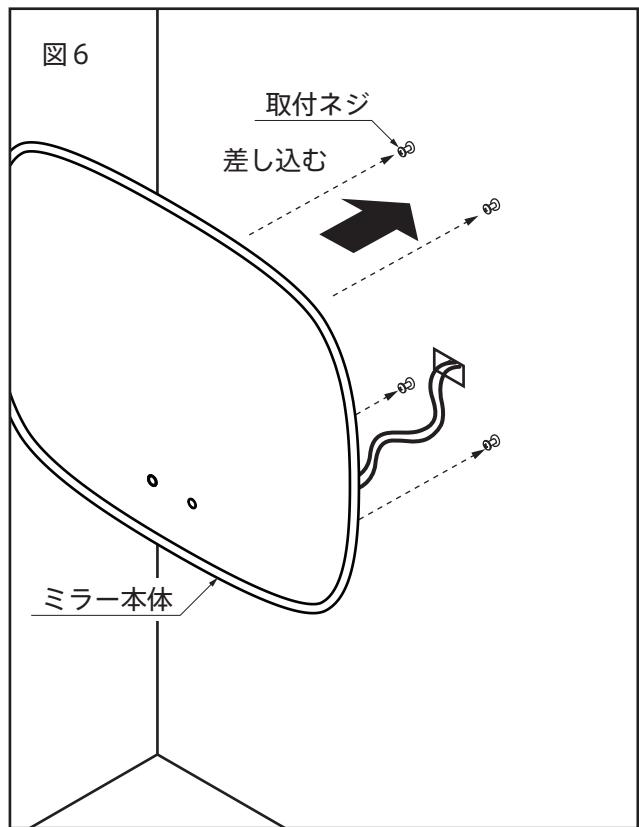
6. ミラー本体裏面の壁面取付穴を取付ネジに差し込みます。
