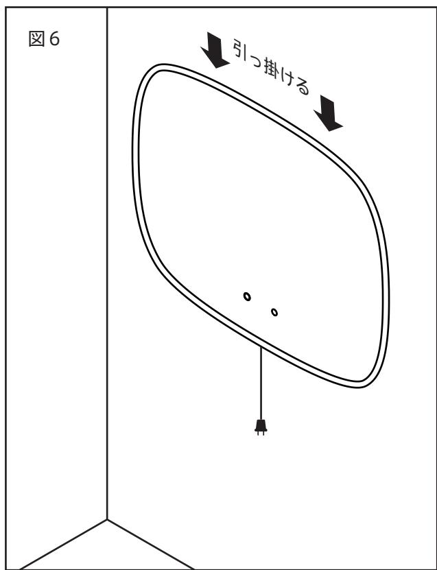
5. ミラー本体裏面の壁面取付穴を取付ネジに差し込みます。
