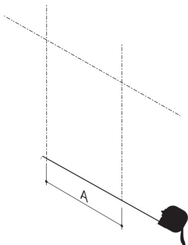
1. ミラー本体裏面の壁面取付穴の位置を計ります。
