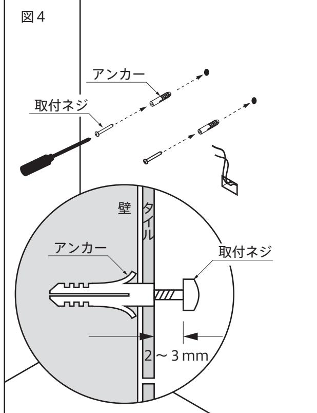
4. 穴を開けた位置にアンカーを使用して、取付ネジを取付けます。
