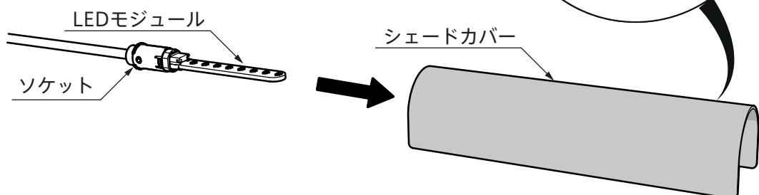
※シェードカバーを引き抜いた時、LEDモジュールが付いていなかった場合、シェードカバー内のLEDモジュールをシェードカバーを振って取り出してください。
