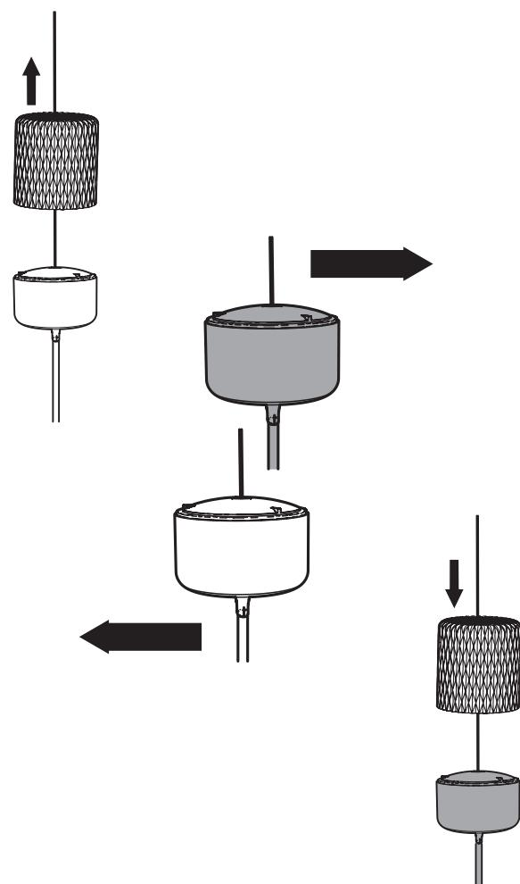
9. ワイヤーフックにワイヤー吊りコードを入れ、ストッパーを押してワイヤー吊りコードの長さを調整します。
