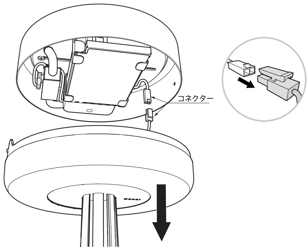
3. 中心にあるキャップを反時計回りに回して外してから、プレートをカバーキャップ下部より下に向かって取り外します。
