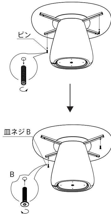
5. ピンを外し、残りのネジB(2ヶ所)と交換します。
