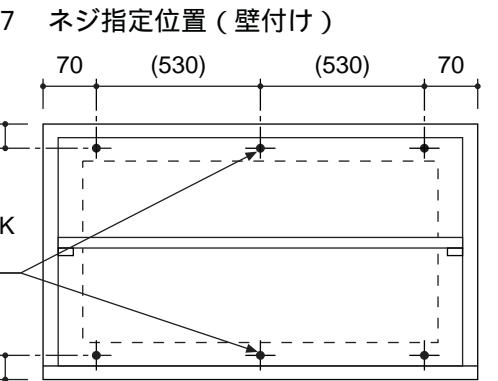
図7 ネジ指定位置(壁付け)
