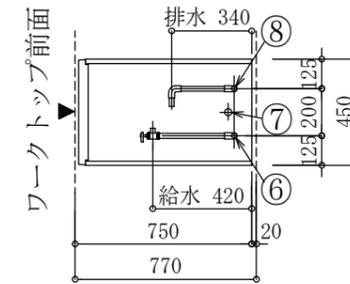
食器洗浄機配管 (平面)
