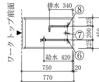
食器洗浄機配管 (平面)
