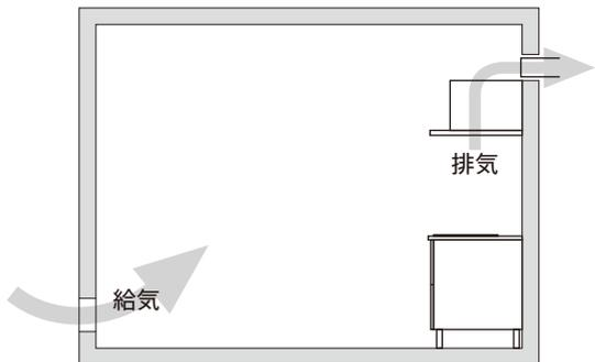
※排気用ダクトの大きさ以上の給気口を排気口と対称の壁に設けると有効です。
